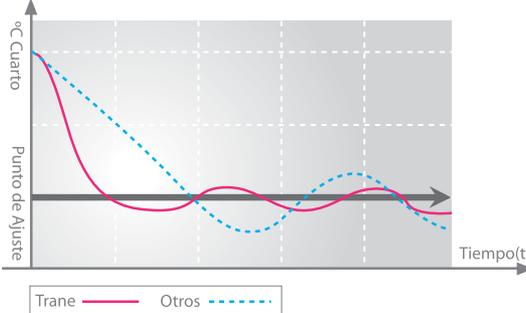
Mínima frecuencia de 15Hz ofrece control de precisión de la temperatura
